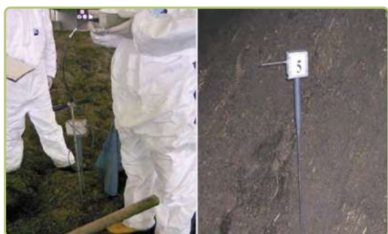
Sonde che rilevano le temperature dei cumuli
